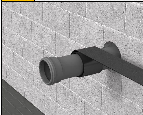
Pav.9 Degūs vamzdžiai su viena eile juostos standžiose sienose, kurių storis A \geq 150 mm
