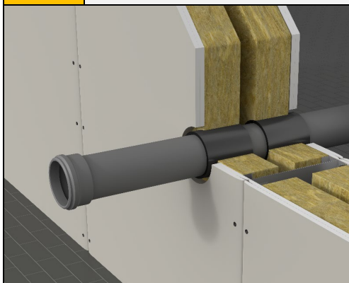
Fig.4 Degūs vamzdžiai su dviem eilėmis juostos lanksčiose arba standžiose sienose, kurių storis A \geq 125 mm
