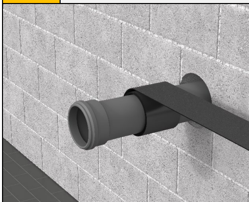
Pav.1 Degūs vamzdžiai su viena eile juostos lanksčiose arba standžiose sienose, kurių storis A \geq 100 mm
