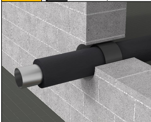
Pav.12 Nedegūs vamzdžiai (su šildymo kabeliu/be šildymo kabelio), kurių izoliacija yra ištisinė (CS), su vienos eilės juosta standžiose/lanksčiose sienose, kurios storis A \geq 100 mm
