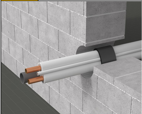
Pav.22 Degių / nedegių vamzdžių / nedegių / nedegių vamzdžių ir kabelių pluoštas standžioje sienoje, kurių storis A \geq 150 mm
